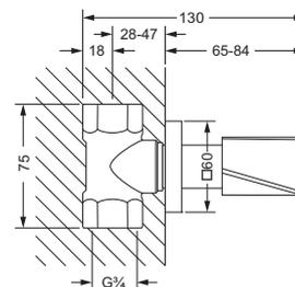
mit Einbaukörper 3/4"
