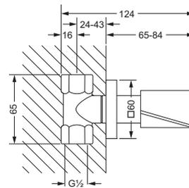
mit Einbaukörper 1/2"
