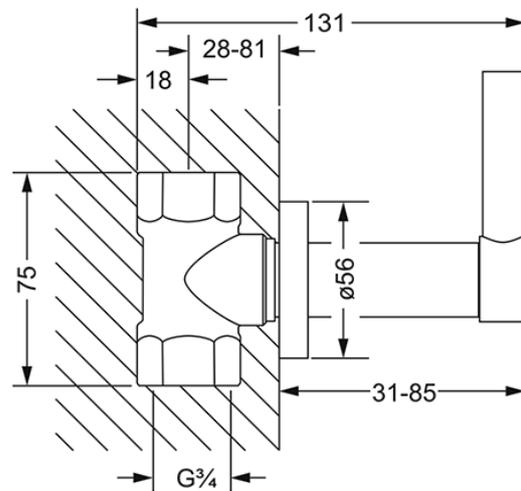
mit Einbaukörper 3/4"
