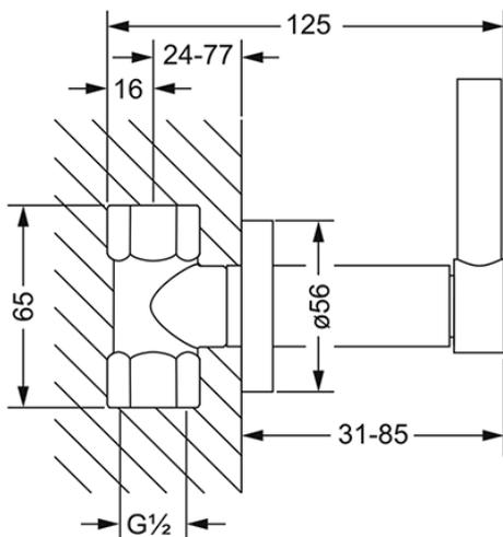
mit Einbaukörper 1/2"
