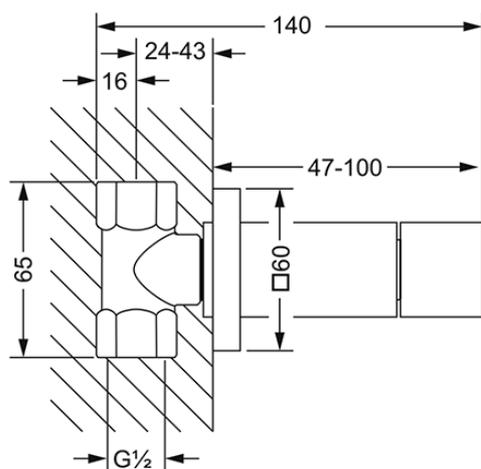
mit Einbaukörper  $\frac{1}{2}$ "
