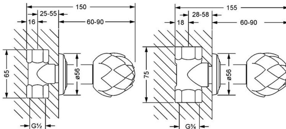
mit Einbaukörper / with concealed body 1/2"
