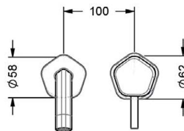
mit Einbaukörper / with consealed body 649.20.362.000
