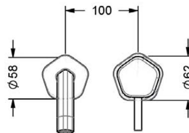
mit Einbaukörper / with consealed body 649.20.362.000
