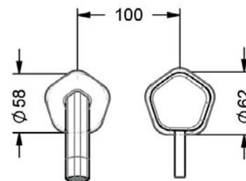
mit Einbaukörper / with consealed body 649.20.362.000
