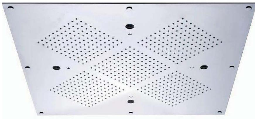
Ультратонкая душевая панель Jörger, представленная на выставке во Франкфурт-на-Майне, насчитывает 605 форсунок, способных подавать до 20 литров воды в минуту при напоре в 3 бар. Каждая форсунка оснащена прозрачным силиконовым наконечником для легкого очищения от известковых отложений.
